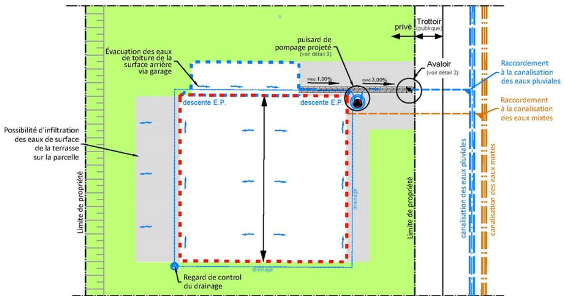
FIGURE 3 – Exemple vue en plan
