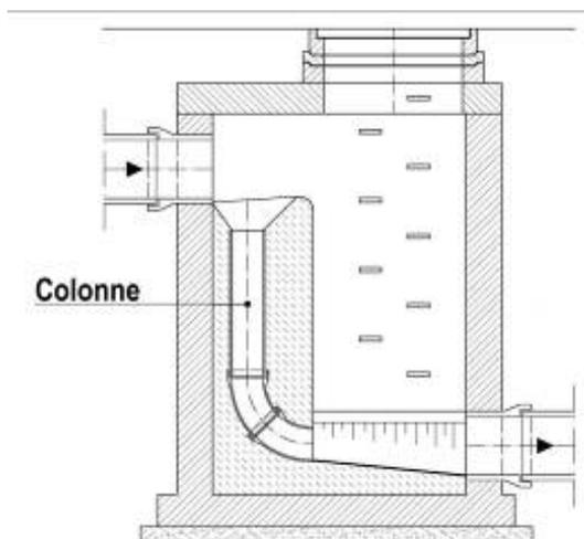
FIGURE 7 – Exemple d'un raccordement dans un regard avec colonne de chute à l'intérieur.
