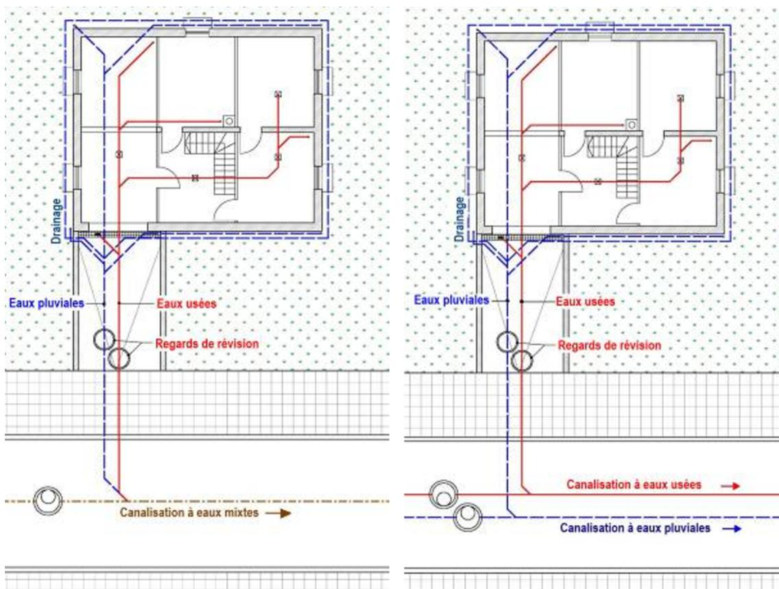
FIGURE 1 – Exemple d'un raccordement sur une canalisation du type à eaux mixtes et du type séparatif
