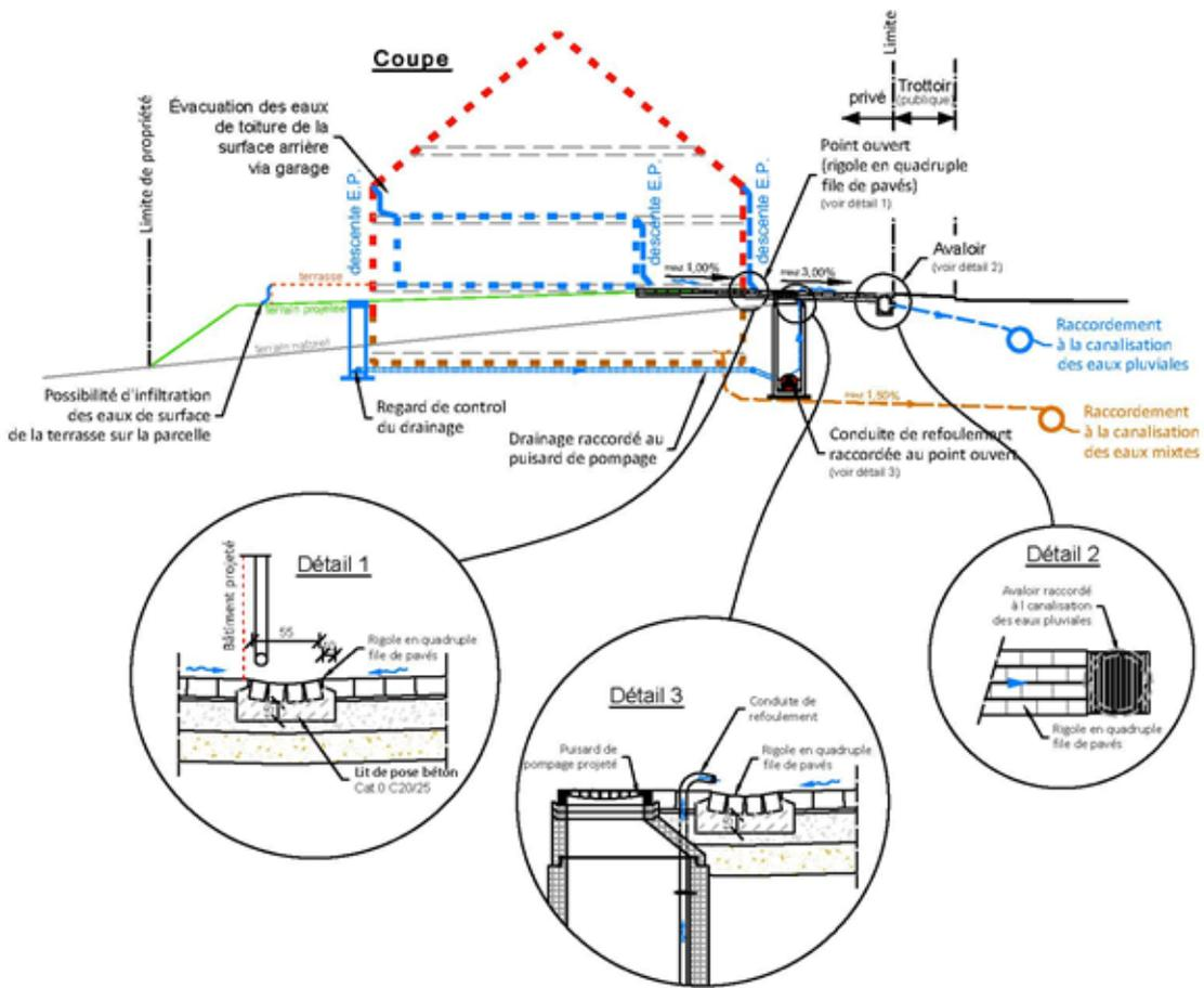
FIGURE 2 – Exemple raccordement maison avec garage et drainage, terrain à l'arrière
