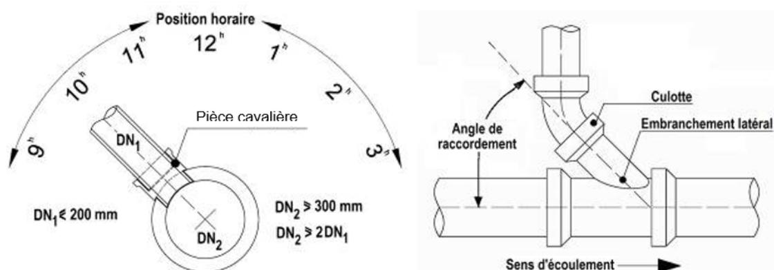
FIGURE 4 – Exemple d'un raccordement par carottage et d'un raccordement par embranchement latéral (culotte).
