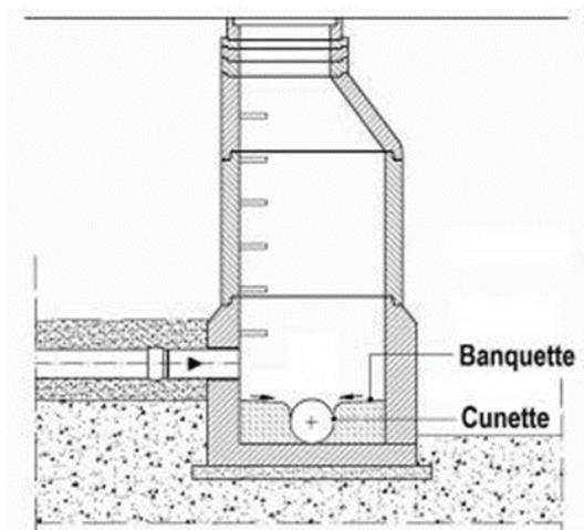
FIGURE 5 – Exemple d'un raccordement dans un regard.
