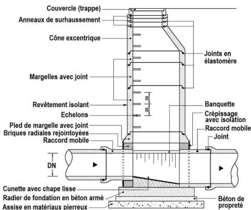
FIGURE 9 – Exemple d'un regard type pour canalisation
