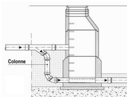
FIGURE 6 – Exemple d'un raccordement dans un regard avec colonne de chute à l'extérieur.
