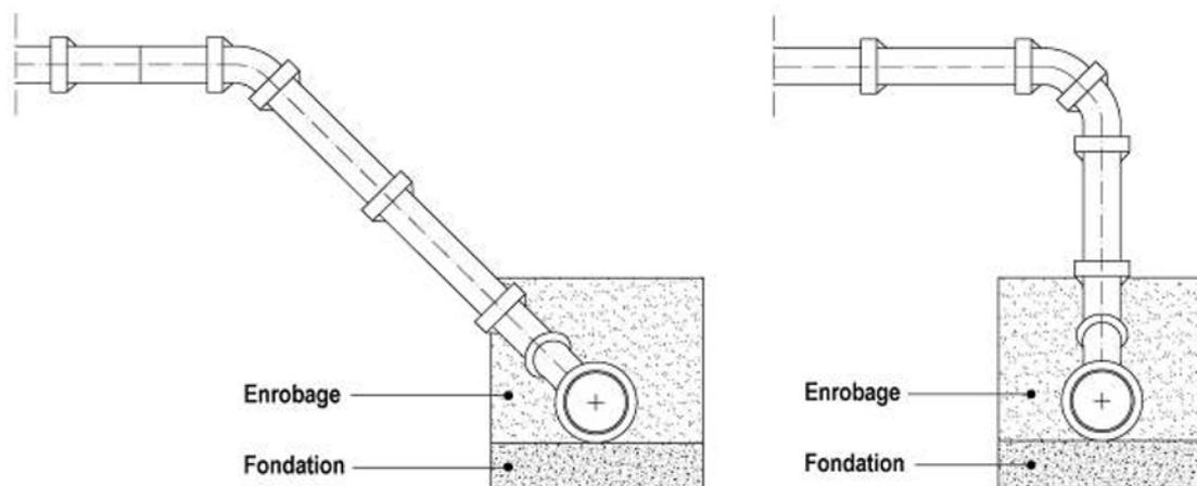
FIGURE 8 – Exemple d'une chute de raccordement à 45° et d'une chute verticale, avec stabilisations.
